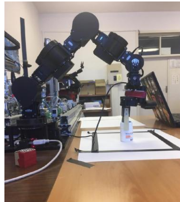
Fig. 5.8 Testarea în condiții de laborator a manipulatorului robotic cu 7DOF utilizând cutii ce au capacele divers colorate.
