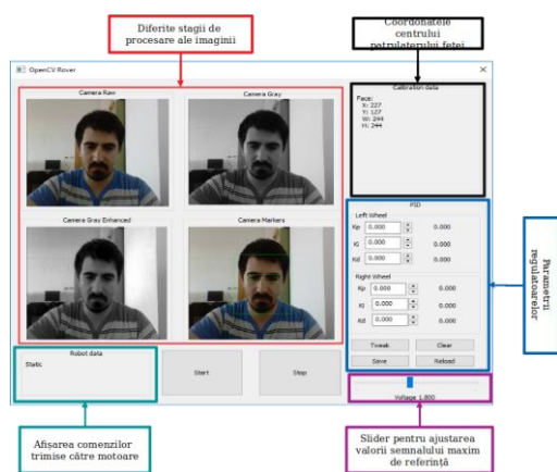
Fig.5.1 Testarea în condiții de laborator a structurii de conducere utilizând mișcările capului unei persoane cu dizabilități locomotorii severe: a) interfața grafică, b) testarea în timp real a SAC-SI
