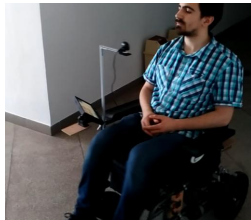
Fig.5.1 Testarea în condiții de laborator a structurii de conducere utilizând mișcările capului unei persoane cu dizabilități locomotorii severe: a) interfața grafică, b) testarea în timp real a SAC-SI
