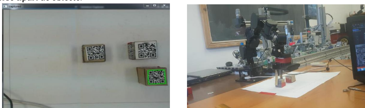
Fig. 5.6 Testarea în condiții de laborator a manipulatorului robotic cu 7DOF utilizând cutii ce au atașate coduri QR.
