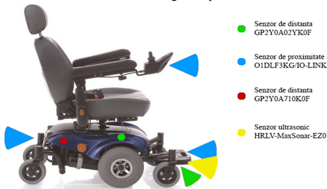
Fig. 3 Propunere de amplasare a senzilor de distanta pe platforma mobila
