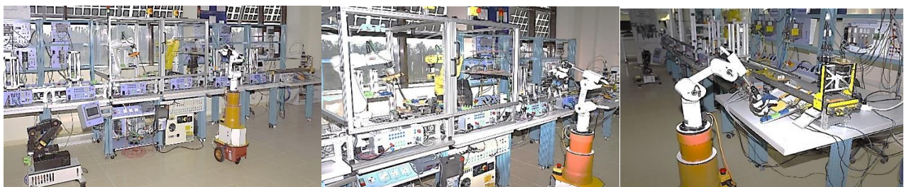
Figure 6. Linia de fabricație flexibilă de precizie, de laborator, asistată în procesul reversibil de dezasamblare de SAC-VAM (2DW/1FW), robot mobil echipat cu Manipulator 6-DOF, cu conducere integrată în tehnologii de asistare
