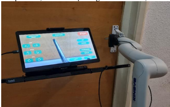
Fig. 4.1.4. Camera web montată pe efulor final și imaginea afișată pe interfață
