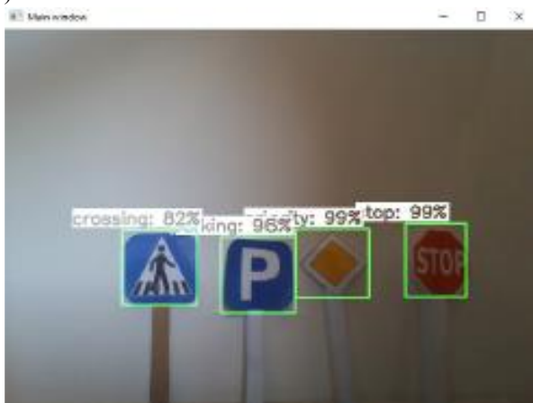
Fig.4.3.1 a) Model de deep learning care detectează semnele de circulație (trecere de pietoni, parcare, prioritate și oprire semn), b) Algoritm de procesare a imaginii pe pista de curse reală, detectarea indicatoarelor rutiere, a liniilor de bandă și calculând unghiul de virare
