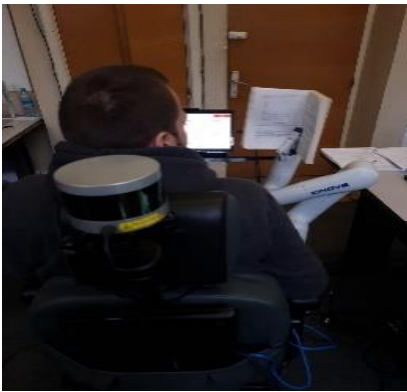
Fig. 4.1.11. Activități zilnice cu ajutorul brațului robotic atașat la scaunul cu roțile
