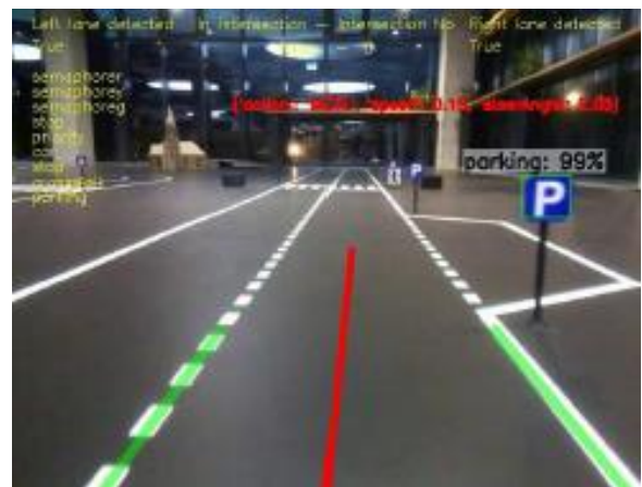
Fig.4.3.1 a) Model de deep learning care detectează semnele de circulație (trecere de pietoni, parcare, prioritate și oprire semn), b) Algoritm de procesare a imaginii pe pista de curse reală, detectarea indicatoarelor rutiere, a liniilor de bandă și calculând unghiul de virare
