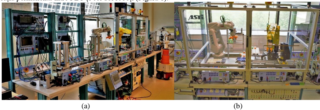
Figura 2. a) SIFF echipat cu sisteme robotice; b) robot ABB robot (stânga), robot FANUC și SCARA (dreapta)
