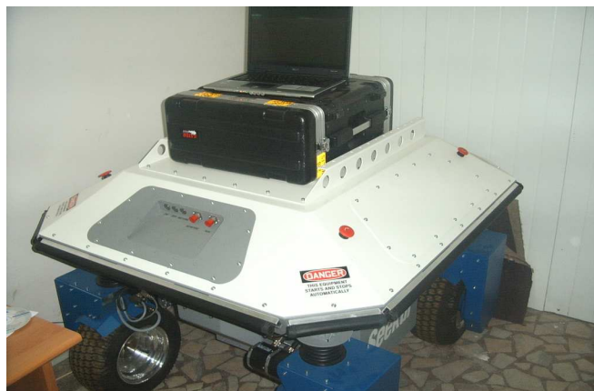
Figura 1.b.1. Vehiculul autonom Seekur 4DW/ 4SW
